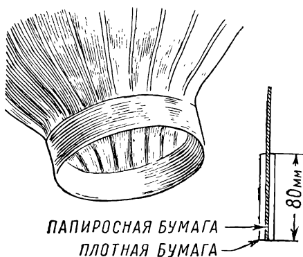
Рис. 26. Выклеивание кольца для горловины шара.
